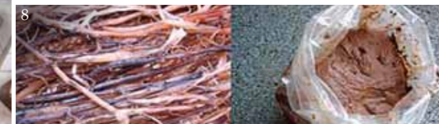
Figura 8. Amostras deterioradas em consequência da coleta com solo encharcado ou devido ao armazenamento em más condições.
