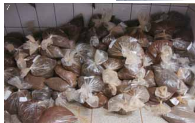
Figura 7. Armazenamento das amostras em galpão, em local fresco, sem incidência direta do sol.
